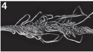
4 Časté kroucení ovlivňuje jenom vnitřní (nejkratší) pramen. Ten jediný leží natažený na ocelovém laně.
