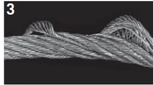
3 Ocelová lana s dvojitým souběžným navinutím pramenů jsou citlivá na zkroucení. Zde došlo k prodloužení vnitřních pramenů, což je vytlačilo ven.
