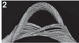
2 Kvůli rotaci (zkroucení) ve směru otáčení ocelového lana se „nekroutové“ ocelové lano zkrátilo a jádro prodloužilo.
