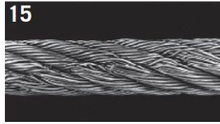
15 Toto lano bylo taženo přes okraj kladkostoje. Všimněte si stopy poškození.
