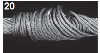
20 Ještě jedno vytvoření košíku na nekroutivém laně.
