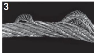
3 Ocelová lana s dvojitým souběžným navitím pramenů jsou citlivá na zkroucení. Zde došlo k prodloužení vnitřních pramenů, což je vytlačilo ven.
