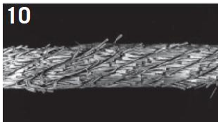
10 Toto ocelové lano pracovalo v příliš úzkém kladkostroji.
