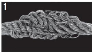
1 Ocelové lano po „oloupání“ vnějších pramenů. Dobře viditelné hromadění přebytečných délek
