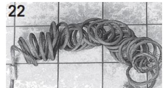
22 Pokud se ocelové lano táhne přes ostré hrany, má sklon se v nezatiženém stavu navíjet.
