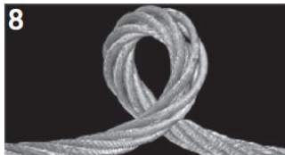
8 Toto lano se zkroutilo ve směru otevírání (odvíjení) ocelového lana. V nezatíženém stavu tvoří smyčku ve směru otáčení lana. Po zatížení lana se smyčka utáhne a může trvale změnit tvar lana.
